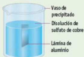
Figura 4.13 Disolución de sulfato de cobre con lámina de aluminio.
