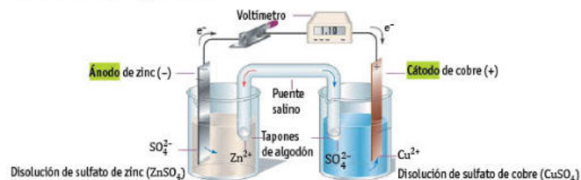
Figura 4.22 Dispositivo que representa una pila galvánica.
