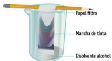
Figura 1.23 Cromatografía en papel. La fase estacionaria es el papel filtro y la fase móvil, el disolvente.
