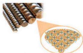
Figura 2.56 Corte transversal de un metal. Las cargas positivas representan al núcleo; los círculos verdes en movimiento forman el mar móvil de electrones.
