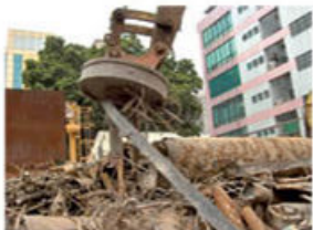
Figura 1.29 Separación magnética de chatarra.
