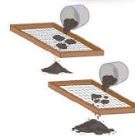
Figura 1.24 Los granos más pequeños atraviesan el tamiz y los más grandes son retenidos. De esta forma se separan dos o más sólidos.
